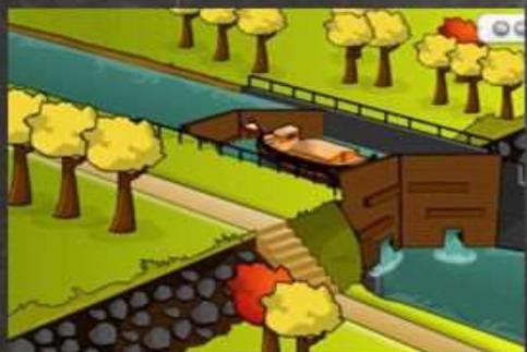
L'eau du sas s'écoule par les vannes ouvertes.
